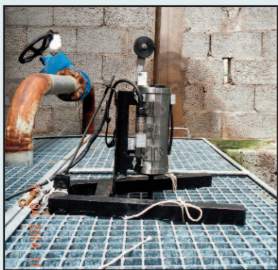
Ensayo electromagnético de cables
