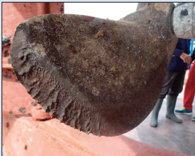
Pala de la hélice de un pesquero erosionada en el extremo de su cara de succión por efecto de la cavitación.
