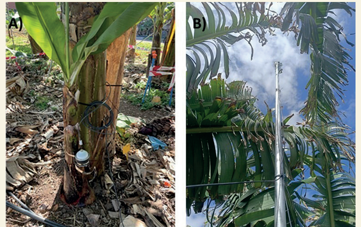
Figura: A) Dendrómetros de banda instalados alrededor del pseudotallo de las plantas de plátano, B) Sensores de termometría infrarroja instalados sobre el dosel de las plantas de plátano
